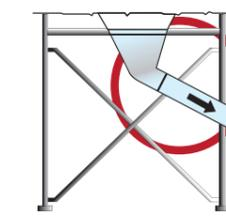
Fond pour vidange latérale avec sortie adaptable au tuyau de vidange.
